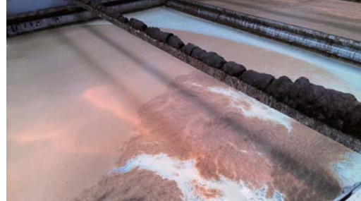
PAC 저감 및 유기용결제 적용 시 부상 압밀성 개선 상태
